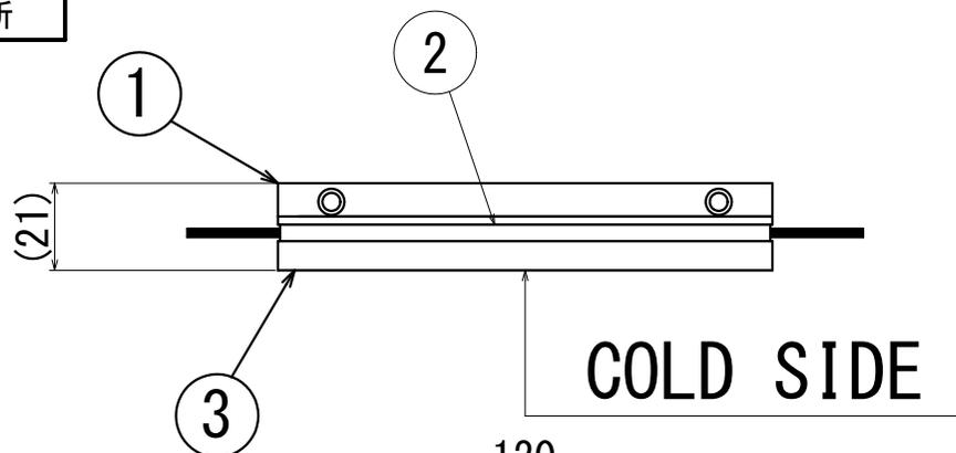
最大吸熱量 :  $\Delta T=0[^\circ\text{C}]$  400 [W]
